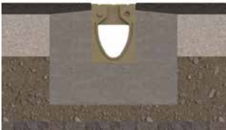
Pose en chaussée asphalte ou enrobée
