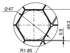
Diamètre optimal de 47 mm pour la structure alvéolaire
