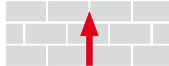
Prévoyez un joint de dilatation d'au moins 3 cm entre les dalles et les bordures. Ceci permettra d'absorber parfaitement la dilation due aux variations de températures.
