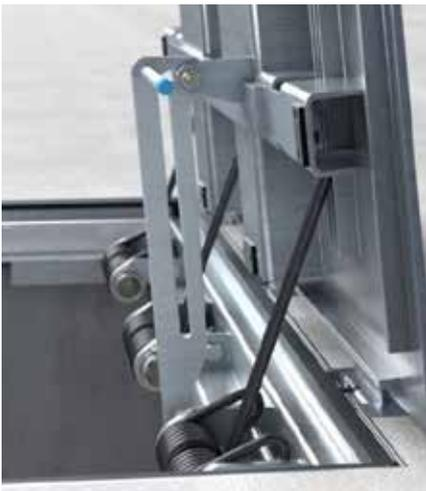
Vérifier l'état du bras de sécurité anti-retour, s'il est tordu ou endommagé il faut le remplacer !
