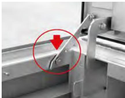
Vérifier l'état du bras de sécurité anti-retour, s'il est tordu ou endommagé il faut le remplacer !
