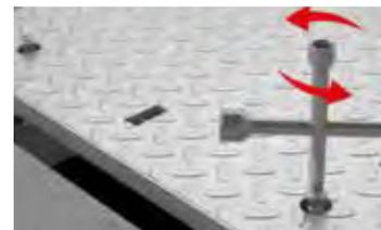
Dévisser les vis du couvercle à l'aide de la clé de manœuvre ou d'une clé à choc
