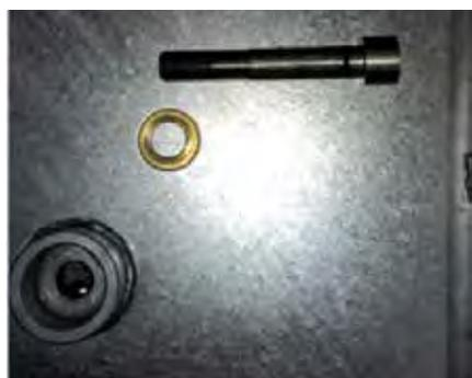
Dévisser les vis du couvercle et les conserver dans un endroit sûr avec les rondelles en laiton
