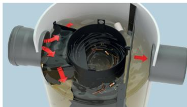
Lors des débits intenses, lorsque le déversoir est en action, le déviateur de sortie bloque les débris flottants à l'intérieur de l'appareil.
