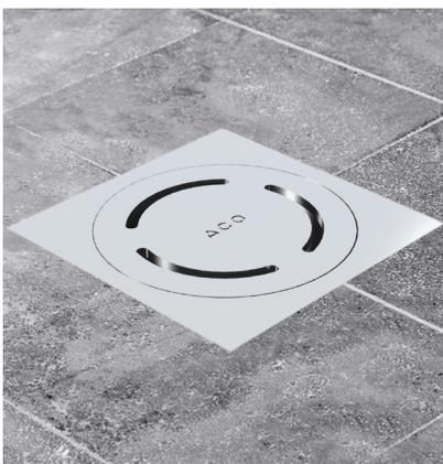
Disponible dans de nouvelles dimensions en sortie horizontale (150x150 mm et 200x200 mm), ce siphon non verrouillé à cloche siphonoïde solidaire, de diamètres pouvant aller de 40 à 63 mm, permet un débit d'évacuation rapide et silencieux de 0,25 l/s à 0,9 l/s.
