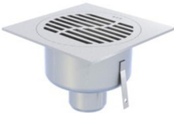
De dimensions compactes (100x100 mm, 150x150 mm), **ACO Showerdrain Design** garantit des performances sans faille (débits 0.3 l/s ou 0.7 l/s) avec trois capacités de garde d'eau de 15 et 30 mm pour la rénovation basse hauteur et de 50 mm conforme à la norme NF EN1253.
