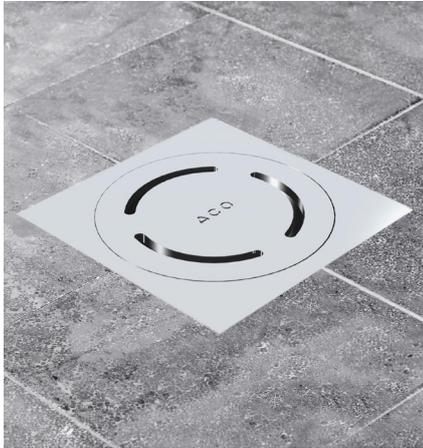
Disponible dans de nouvelles dimensions en sortie horizontale (150x150 mm et 200x200 mm), ce siphon non verrouillé à cloche siphonide solidaire, de diamètres pouvant aller de 40 à 63 mm, permet un débit d'évacuation rapide et silencieux de 0,25 l/s à 0,9 l/s.
