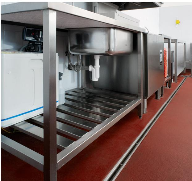
**ACO Modul** est un caniveau en acier inoxydable, à fente (largeur 20 mm) ou à grille (largeur de 125 ou 200 mm), avec ou sans pente intégrée, utilisé pour délimiter les zones sèches des zones humides, sur des sols où le nettoyage présente un débit modéré (de 1,2 à 4,5 litres/seconde).
