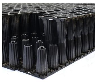
Après terrassement des trois bassins, le fond de fouille a été recouvert d'un lit de pose de 10 cm (constitué de gravillons et de graviers concassés) puis un géotextile filtrant de 200 g/m² est venu envelopper la structure modulaire afin d'éviter toute pénétration de terre. L'étanchéité de l'ouvrage est assurée par une membrane imperméable qui elle-même est protégée par un feutre. Un panneau latéral ferme le bassin sur sa périphérie et supporte aussi latéralement la pression du sol.
