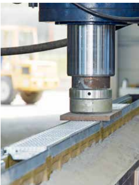
Essai d'étanchéité au terme d'une simulation longue durée
