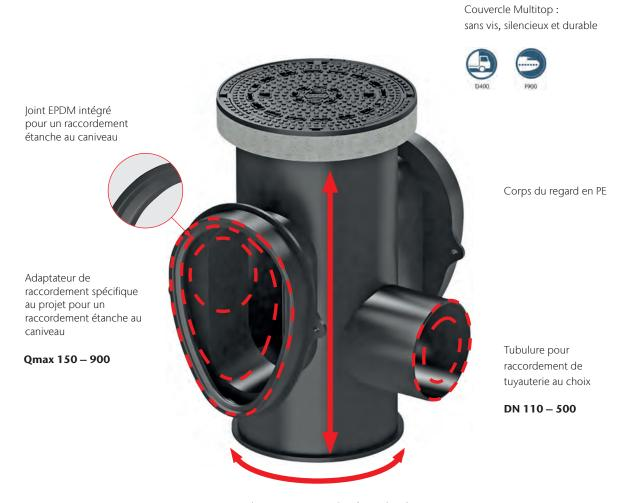
Hauteur de construction et diamètre adaptés aux différentes dimensions du système Qmax
